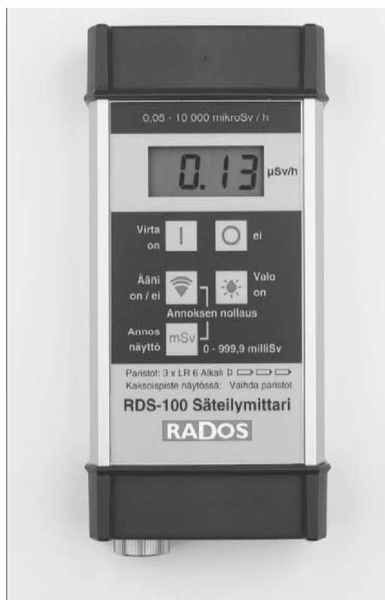
Fig. 10.1. Medidor RDS-100 de Alnor Oy. Este detector es capaz de detectar radiación alfa, beta y gamma. Es capaz también de funcionar como dosímetro.
