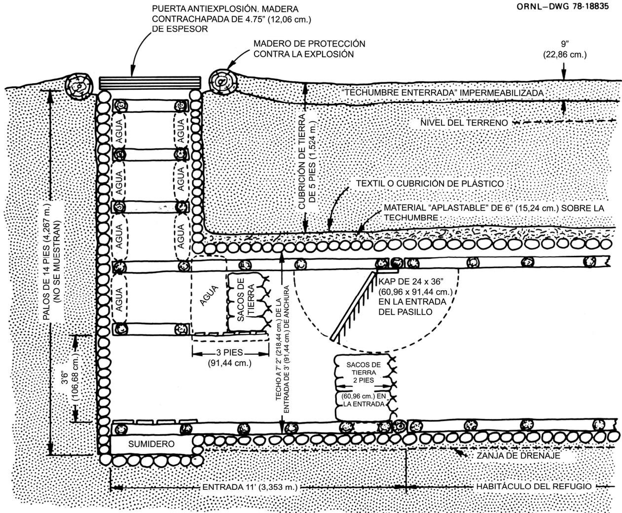
**Fig. D.20.** Entrada del Pequeño Refugio de Leños contra la Explosión resguardado contra la radiación nuclear inicial. Este esquema es una sección vertical simplificada a través de la línea central de un extremo del refugio. ORNL-DWG 78-18835. Nótese que el agua que se almacena en torno al pozo de la entrada tiene por objeto absorber la radiación neutrónica.
