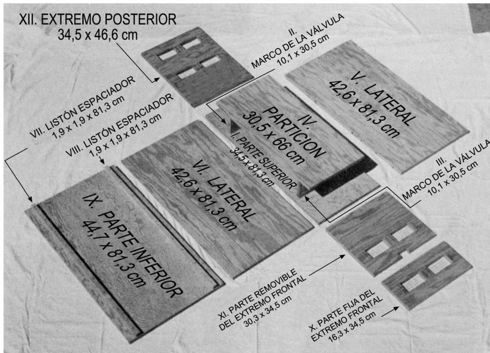
**Fig. 12B.** (Serie B - Medidas españolas). Partes de la "caja" de la bomba de aire, con las dimensiones en centímetros. Los números romanos dan el mejor orden comprobado para el ensamblaje de estas piezas unas con otras.
